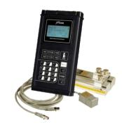
Погрешность: ±1% Скорость потока: 0.01 ~ ±5 м/с Диаметр трубы: 25~1200 мм
